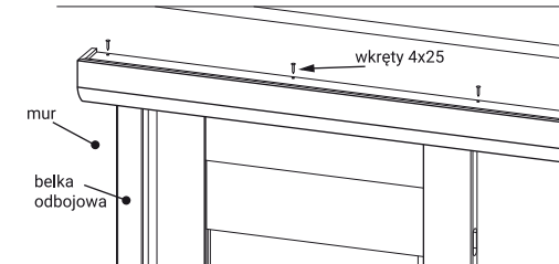
rys. 3 - Zamocowanie maskownicy do systemu przesuwego
